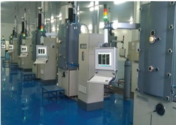
Рис. 3. Производственный участок роста профилированного сапфира на установках “НИКА-Профиль”.
