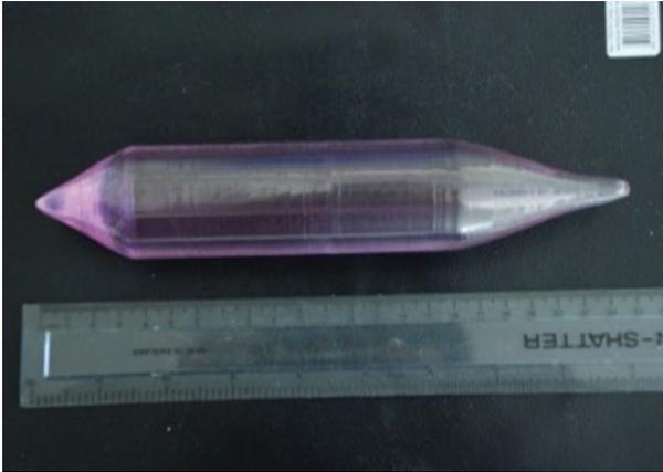
Рис. 2. Кристалл алюмо-иттриевого граната, выращенный на установке “НИКА-3” в автоматическом режиме.
