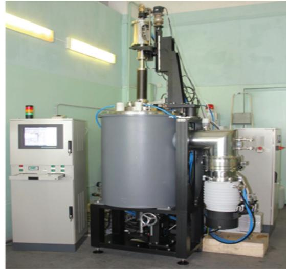
Рис. 5. Установка серии “НИКА-М” для выращивания слитков сапфира методом Киропулоса, оснащенная системой управления процессом роста с обратной связью.
