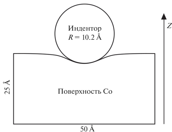
Рис. 1. Схематическое изображение геометрии численного индентирования пленки кобальта.
