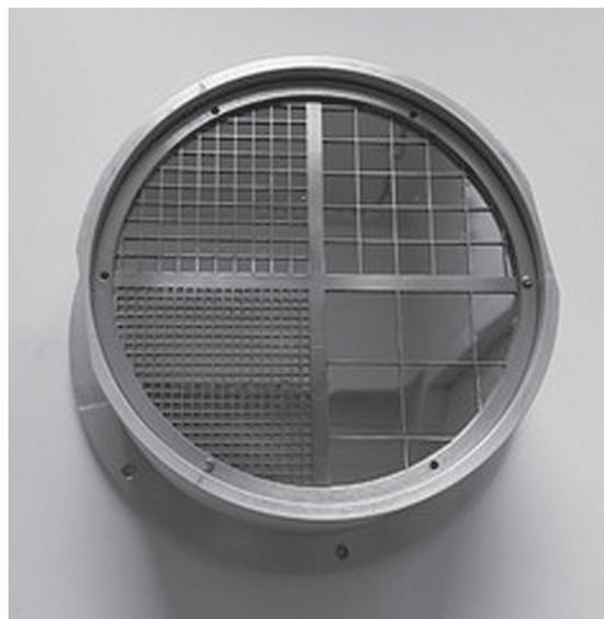
Рис. 5. Макет фильтра для акустических испытаний с ячейкой поддерживающей сетки разных размеров (2.5, 5, 10 и 20 мм).
