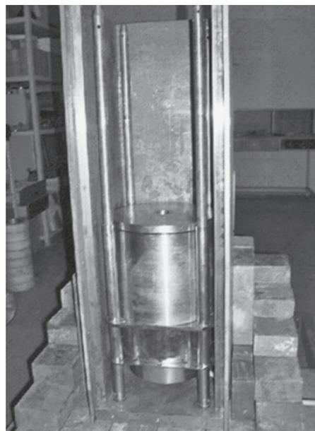
**Рис. 2.** Фотография низкофоновой установки.
