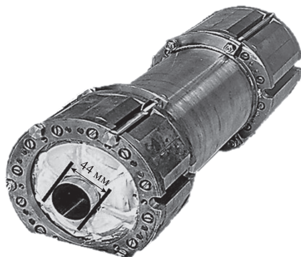
Рис. 3. Внешний вид сверхпроводящих секступольных магнитов до их помещения в криостат.
