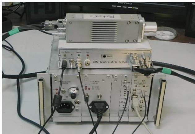
Рис. 1. Анализатор рентгеновского и  $\gamma$ -излучений “Радиант”. Сверху вниз – блок детектирования, источник питания, электронные модули в стандарте “Евромеханика”.
