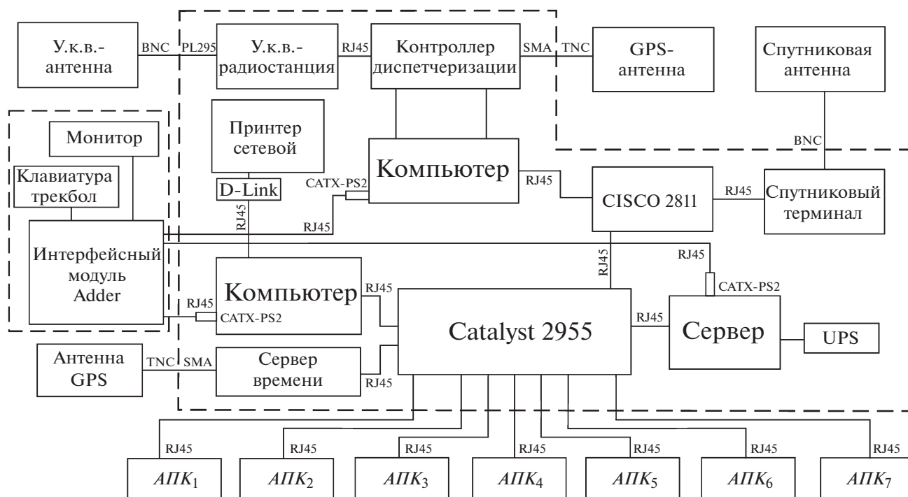
Рис. 1. Принципиальная схема б.и.в.к. самолета-лаборатории Як-42Д "Росгидромет".
