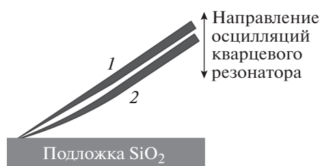
Рис. 1. Схема крепления зонда при реализации “гибридной” моды а.с.м. 1 — положение зонда в наивысшей позиции при колебании кварцевого осциллятора, 2 — положение зонда в самой низкой позиции.
