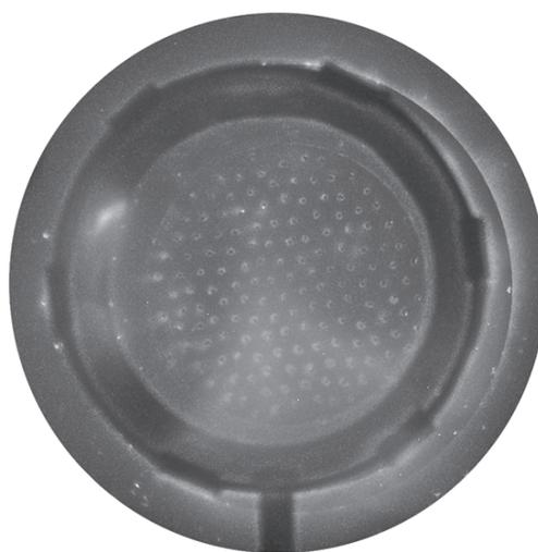
**Рис. 3.** Фотография свечения катода. Амплитуда импульса ускоряющего напряжения 30 кВ, давление аргона 0.4 мТорр, индукция внешнего ведущего магнитного поля 0.11 Тл.
