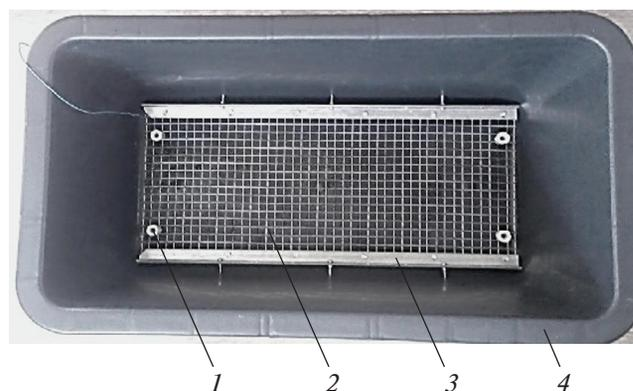
Рис. 1. Фотография емкостного анализатора осадков. 1 – электрический конденсатор, 2 и 3 – его плоские электроды, 4 – сборник жидкого фильтрата.
