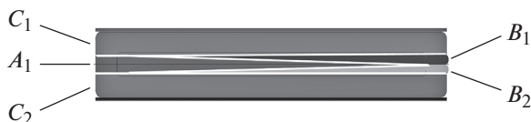
Рис. 2. Структура одной из пяти коллекторных групп анода детекторного узла прибора ПИПЛС-Б.
