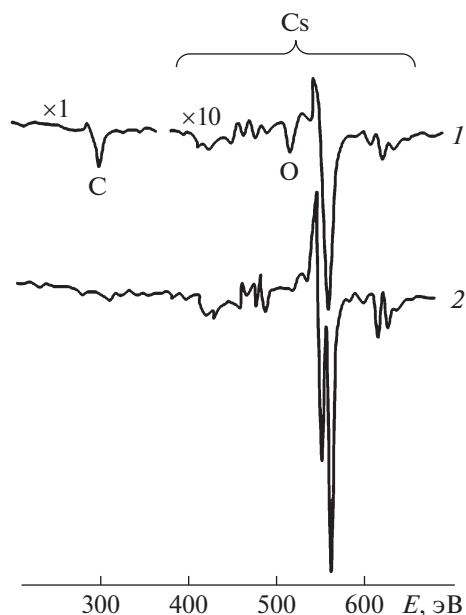
Рис. 2. Оже-спектры поверхности Cs до (спектр 1) и после очистки (спектр 2) поверхности электронной бомбардировкой ( E_p = 1000 эВ, 50 мкА/мм 2 , 20 с).
