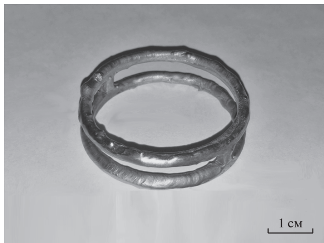
Рис. 6. Молибденовый нагревательный элемент для индукционной печи.
