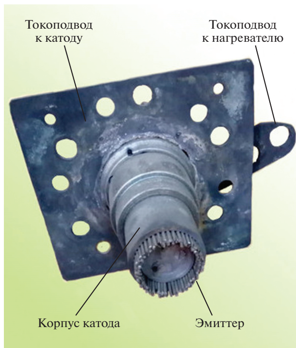
Рис. 3. Катод источника литиевой плазмы.
