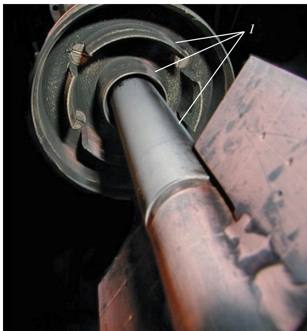
Рис. 11. “Тень” на коллекторе обедненного лития от коллектора обогащенного при выключенном циклотронном нагреве. I – места без осадка лития.
