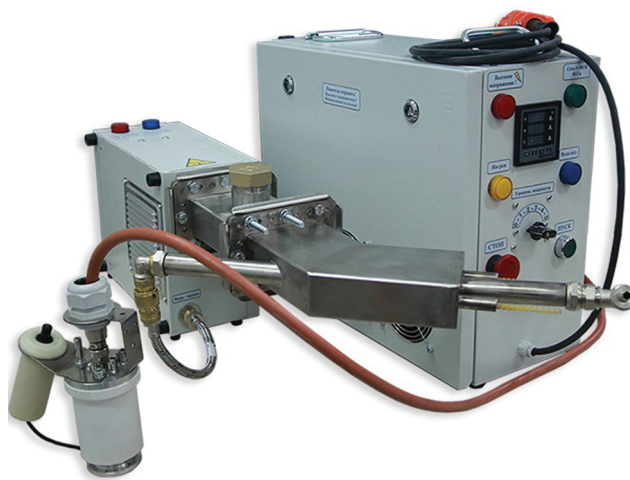
Рис. 1. Общий вид аппаратного комплекса для получения низкотемпературной и нетермальной с.в.ч.-плазмы атмосферного давления.
