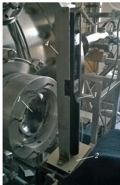
Рис. 2. Фотография оптической системы регистрации сверхзвуковых течений при помощи сканера. 1 – оптическая линза, 2 – юстировочный столик, 3 – сканер, 4 – футляр для сканера с диафрагмой, коллимирующей излучение.
