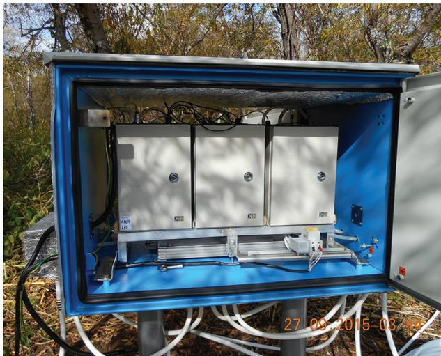
**Рис. 1.** Фотография всепогодного антивандального приборного шкафа в п. Начики (Камчатка) с пятью микробарометрами, системой воздуховодов для локальной сверки/калибровки микробарометров и подключения ветровых фильтров, многоканальным блоком оцифровки и передачи данных на удаленный сервер.
