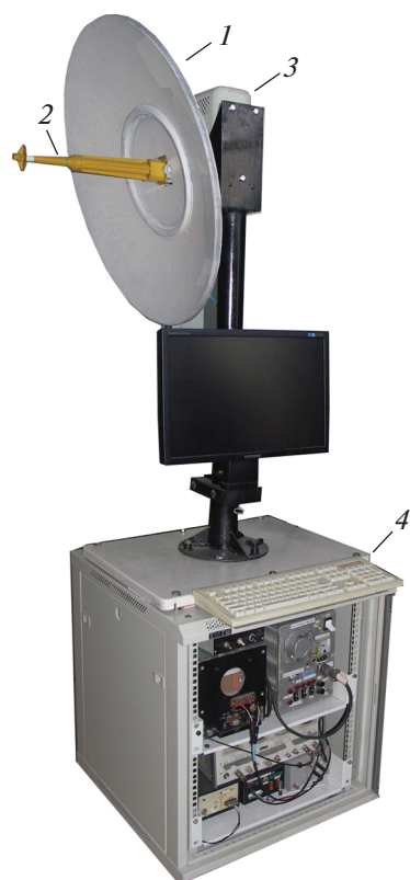
Рис. 6. Внешний вид макета бортового оборудования л.а. на базе самолетной радиолокационной станции “Гроза-26”. 1 – зеркальная антенна; 2 – облучатель с встроенным ферритовым вращателем плоскости поляризации; 3 – антенная колонка; 4 – приемоизмерительная аппаратура.
