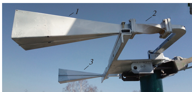
Рис. 5. Внешний вид передающих рупорных антенн радиомаяка. 1 – рупорная антенна горизонтальной поляризации; 2 – волноводная скрутка на 90^\circ ; 3 – рупорная антенна вертикальной поляризации.
