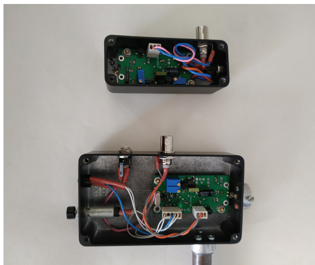
Рис. 1. Общий вид лазерных диодных излучателей (со снятыми крышками) в двух различных металлических корпусах.
