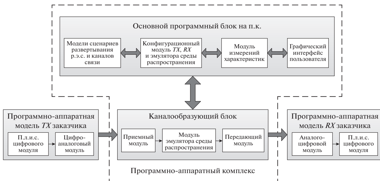
Рис. 1. Блок-схема п.а.к. для проведения натурно-модельных испытаний разрабатываемого приемно-передающего оборудования. ТХ – передатчик, РХ – приемник.
