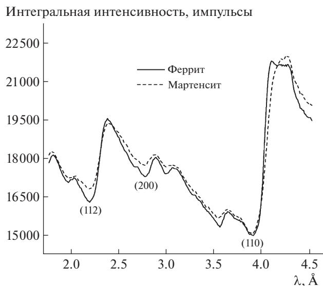
Рис. 4. Зависимости пропускания нейтронов образцами ферритной и мартенситной фаз стали У12 от длины волны нейтронов. Указаны отражающие плоскости ферритной фазы, соответствующие брэгговским скачкам при \lambda = 4.04 \text{ (110)} , 2.86 \text{ (200)} , 2.34 \text{ Å (112)} .
