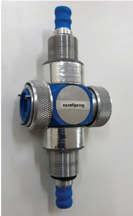
Рис. 4. Калибровочное устройство для градуировки микрофонов.
