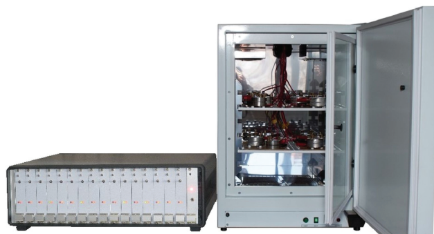
Рис. 2. BT4-100PG с макетами аккумуляторов в термостате.
