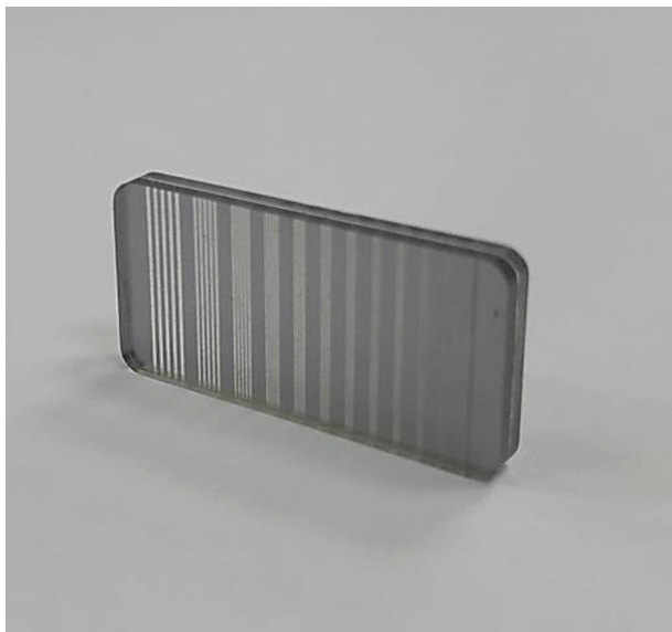
Рис. 4. Индикатор качества изображения для определения базового пространственного разрешения.
