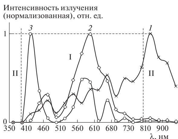
Рис. 7. Спектральные распределения мощности излучения различных осветительных устройств: 1 – лампы накаливания, 2 – светодиода холодного белого света (6000 К), 3 – лазерной лампы малой мощности. I, II – соответственно области спектра видимого и невидимого для глаза человека излучения.
