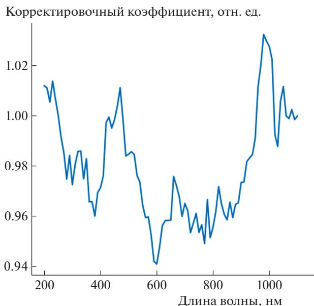
Рис. 4. Зависимость корректировочного коэффициента от длины волны.
