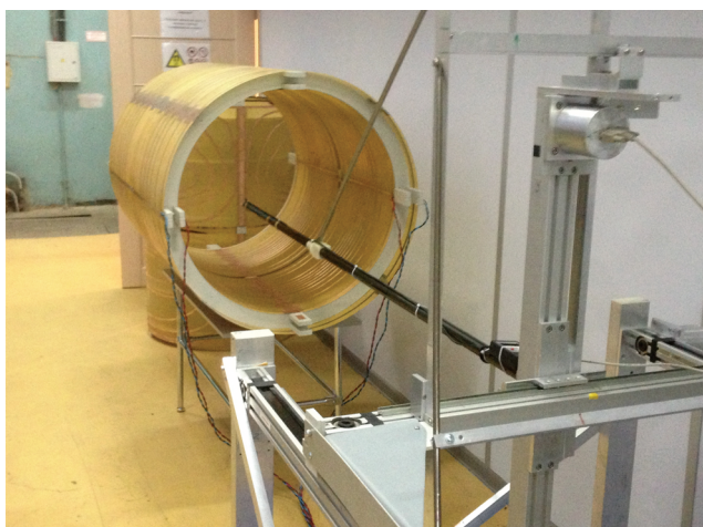
Рис. 17. Макет катушки градиентно-корректирующего модуля.
