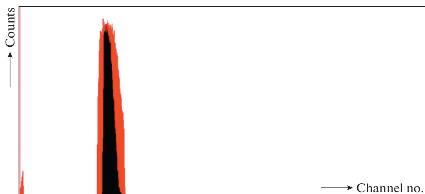
Рис. 10. Сравнение спектров: стробируемый фотопик (красный); фотопик после временной обработки (черный).
