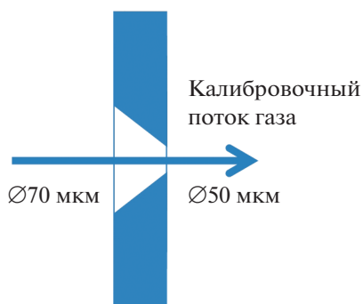
Рис. 6. Схематическое изображение калибровочной диафрагмы.
