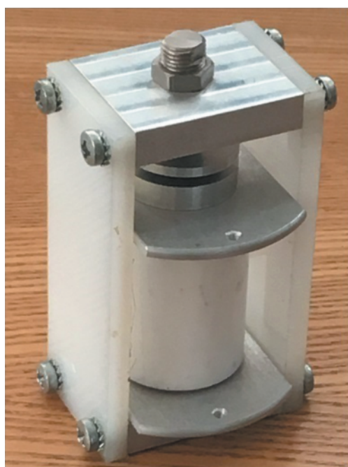
Рис. 2. Блок SID с рабочим напряжением 12 кВ.
