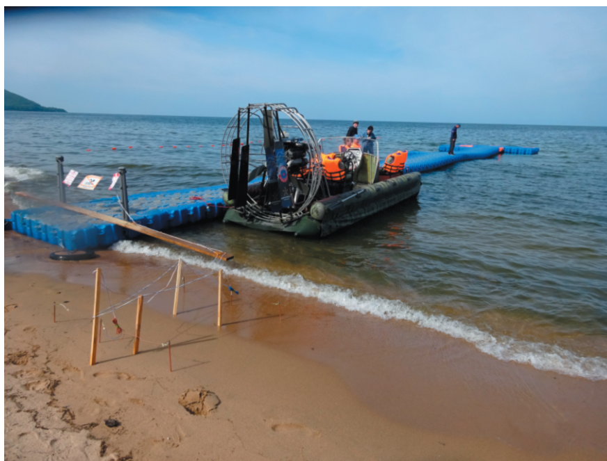
Рис. 2. Конфигурация размещения измерительных электродов на песчаном пляже береговой линии озера Байкал.
