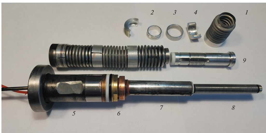
Рис. 1. Сильфонная камера в разобранном виде. 1 – тонкостенный компенсатор давления; 2 – внутренняя втулка; 3 – внешняя втулка; 4 – внешняя разрезная втулка; 5 – плунжер; 6 – уплотнительные кольца; 7 – металлический стержень; 8 – катушка из нихромовой проволоки; 9 – цилиндр с контактом.
