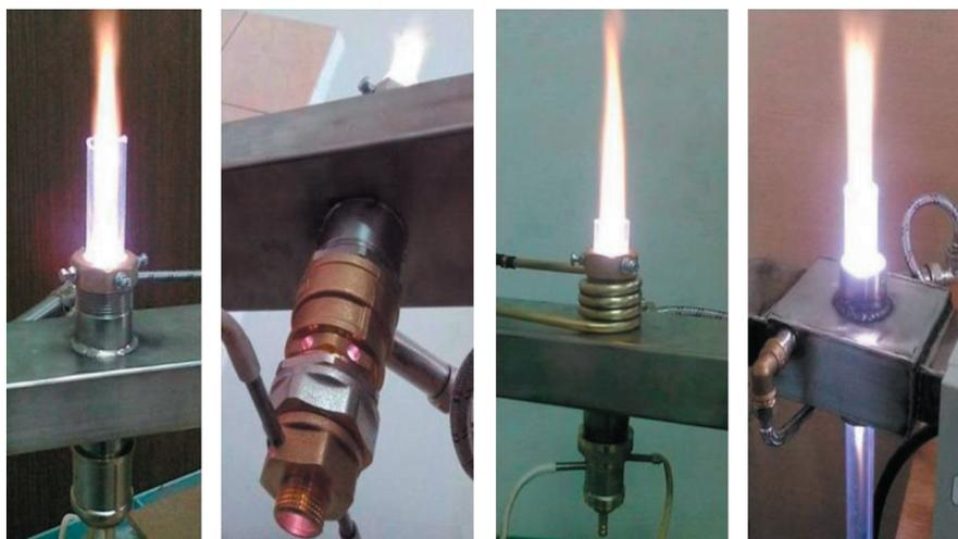
**Рис. 2.** Простой СВЧ-плазматрон на стандартной резьбовой латунной арматуре.
