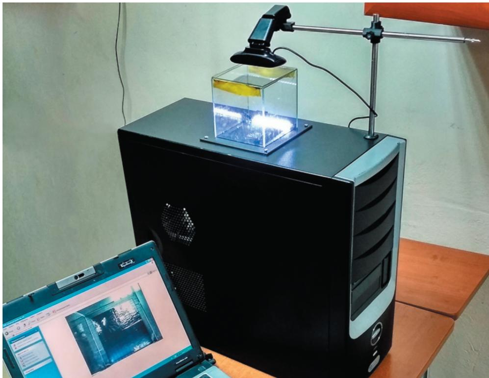
Рис. 4. Фотография портативной камеры Вильсона.
