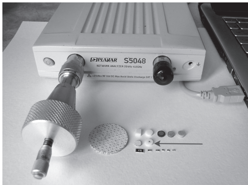
Рис. 1. Общий вид установки с исследованными образцами. Стрелкой указан имитатор дисковых образцов для калибровки прибора, при которой учитываются C и L конусной ячейки. Имитатор имеет в центре диска SMD-резистор с активным сопротивлением около 50 Ом. Режимы XX и КЗ обеспечиваются подвижным электродом с микрометром.
