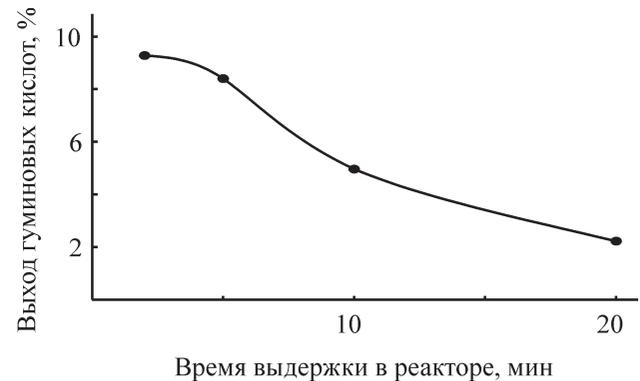
Рис. 1. Влияние продолжительности выдержки торфа в реакторе ВАГ на выход гуминовых кислот.
