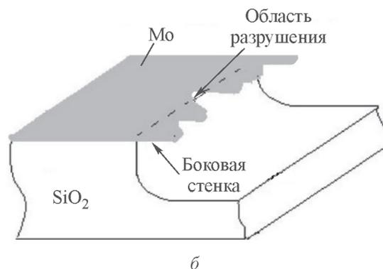
Рис. 4. Разрушение защитной пленки молибдена при длительном травлении стекла (а) и схематичное изображение области после травления (б).
