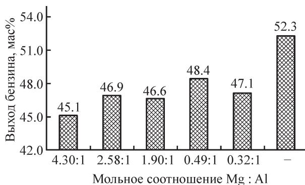
Рис. 3. Выход бензина при крекинге смеси гидроочищенного вакуумного газойля (90 мас%) и подсолнечного масла (10 мас%).
