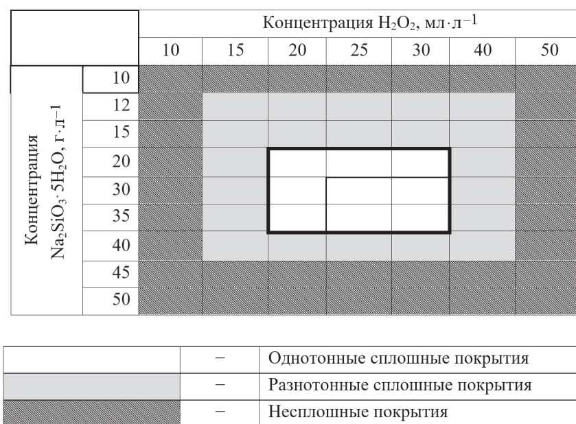
Рис. 1. Диаграмма качества кремнийсодержащих покрытий в зависимости от концентрации основных компонентов раствора.
