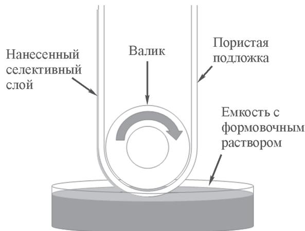
Рис. 1. Схема нанесения селективного слоя на пористую подложку методом касания.
