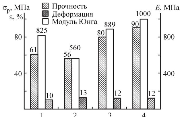
Рис. 3. Физико-механические характеристики полиуретановых композитов, синтезированных без модификатора (1), в присутствии трибутилфосфата (2), *трис*-ацетилацетоната железа(III) (3) и  $[(C_4H_9O)_3P=O]_2ZnCl_2$  (4).
