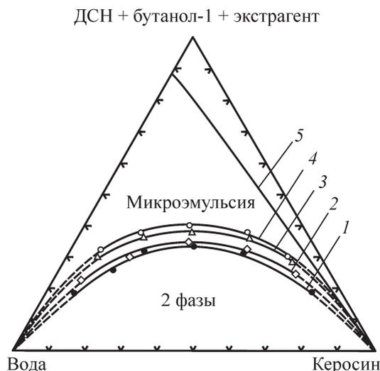
Рис. 1. Псевдотрехкомпонентная диаграмма систем додецилсульфат натрия–бутанол-1–экстрагент–керосин–вода.
