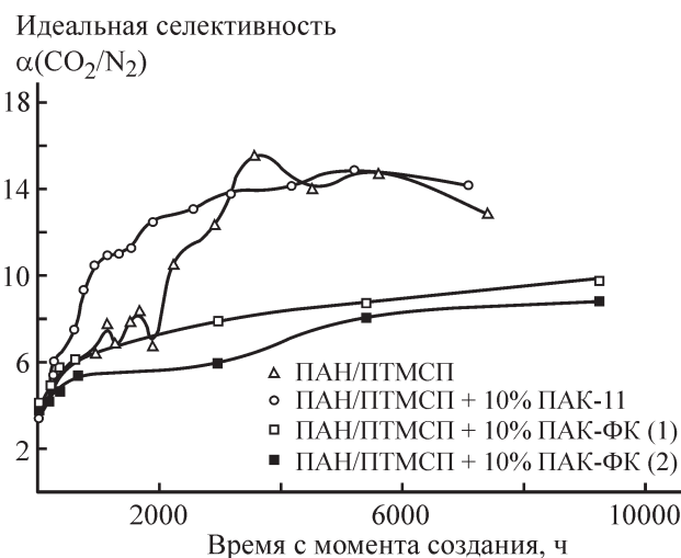
Рис. 3. Зависимость идеальной селективности по паре газов \text{CO}_2/\text{N}_2 от времени жизни композиционных мембран на основе поли[1-триметилсилил-1-пропин]а и наполнителей семейства пористых ароматических каркасов.
