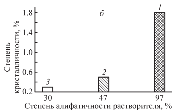
Рис. 5. Зависимость степени кристалличности промышленного парафина от содержания алифатической компоненты в растворителях на основе n -ундекана (а) и газового конденсата (б).
