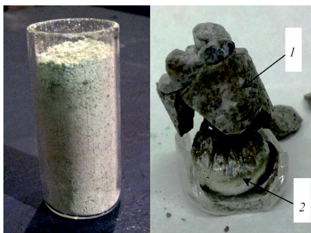
Рис. 2. Кварцевый тигель с шихтой (а), внешний вид конечных продуктов (б): верхний слиток (1) — оксидный \text{Al}_2\text{O}_3/\text{CaO} , нижний слиток (2) — целевой продукт: Cr–Mn–Al–C.
