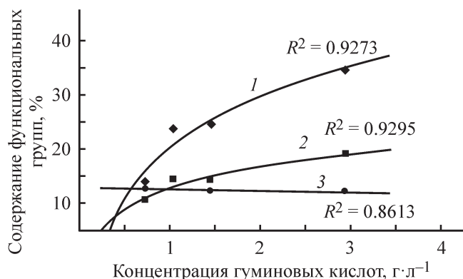
Рис. 3. Количество функциональных групп гуминовых кислот, участвующих в образовании комплекса модифицированных гуминовых кислот в присутствии Fe(III), в зависимости от концентрации модифицированных гуминовых кислот.
