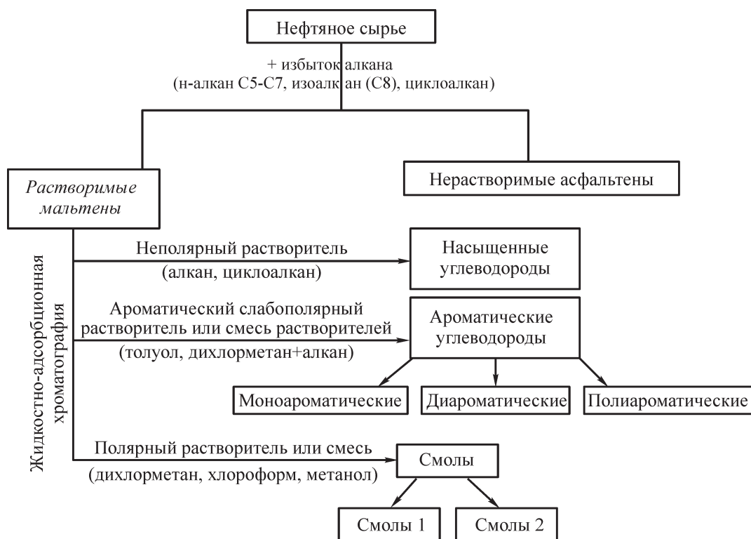
Схема разделения групп углеводородов в нефтяном образце, используемая в методе жидкостно-адсорбционной хроматографии.
