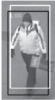
Рис. 5. Пример, демонстрирующий разницу в локализации человека в кадре детектором и алгоритмом визуального сопровождения. Черным цветом нарисовано обнаружение детектора, белым — ограничивающий прямоугольник, полученный алгоритмом визуального сопровождения для того же обнаружения на том же кадре.
