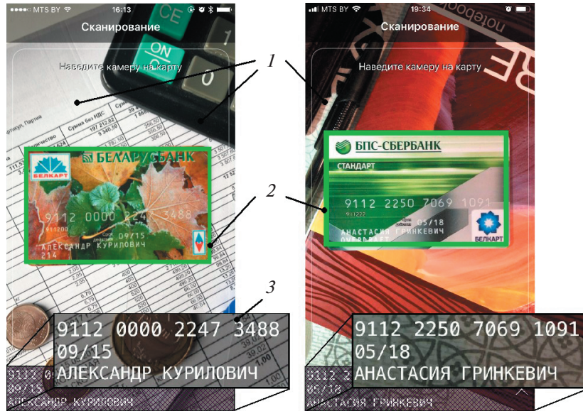
Рис. 2. Внешний вид мобильного приложения, реализующего разработанный алгоритм: 1 – область просмотра изображения; 2 – метка успешного детектирования карты; 3 – область вывода распознанных данных.
