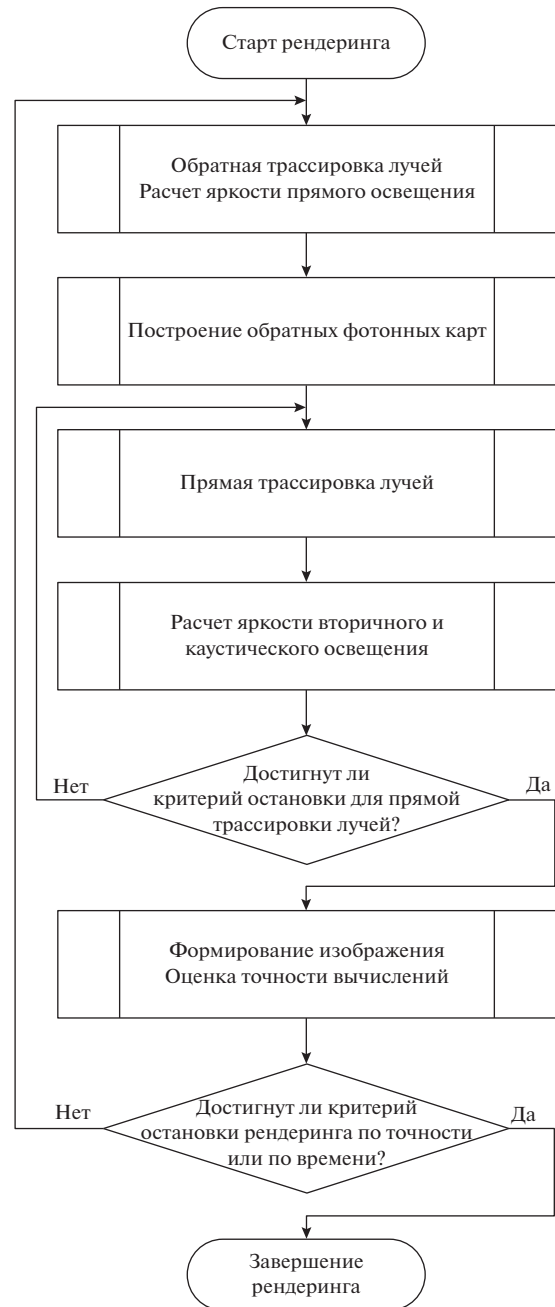
Рис. 6. Блок-схема алгоритма рендеринга методом прогрессивных обратных фотонных карт.
